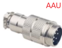
航空电源插头 *2芯10平方 *55A*60V*82mm*φ36*IP65
